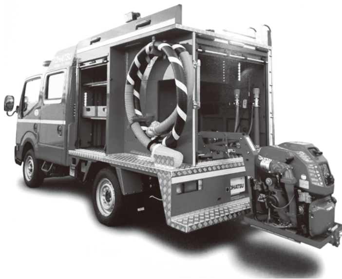
▲小型動力ポンプ積載車(第2分団第2部屯所)
