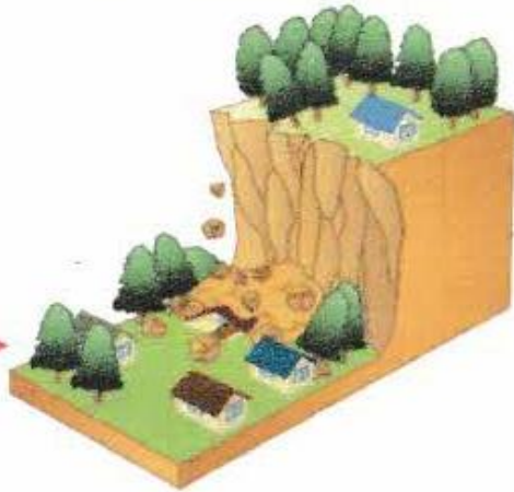
急傾斜地の崩壊(がけ崩れ)
