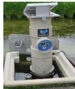
多機能型自動給水栓 (稲作の水管理を自動化・遠隔操作化)
